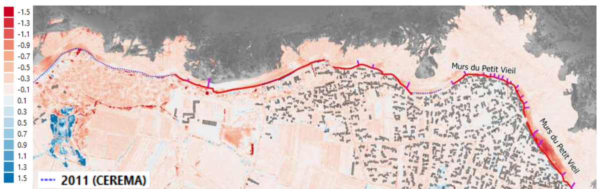
Figure 6.61 : Différences d'altimétries (m IGN69) entre les LiDARS 2022 (PCRS) et 2010 (Litto3D®) entre la pointe de la Gardette et le Grand Vieil.
