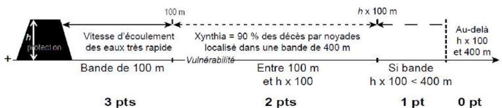
Figure 2.15 : Définition et pondération du Critère 1 pour l'analyse V.I.E. (A.CREACH, 2015).
