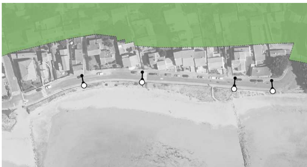
Figure 9.13 : Branches individuelles et indépendantes du réseau EP au droit du boulevard de l'Océan à la Guérinière.
