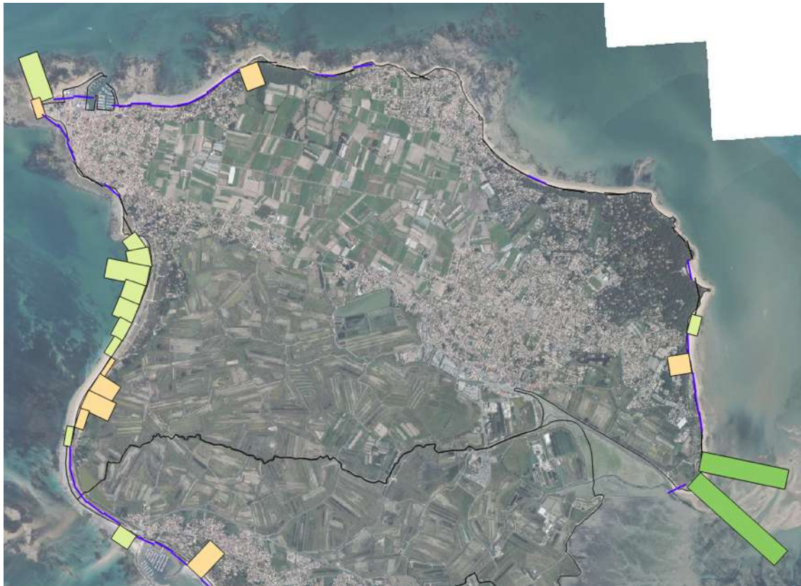
Figure 6.17 : Indicateur national de l'érosion côtière déterminé au droit de Noirmoutier-en-l'Île entre 1949 et 2011 (CEREMA).
