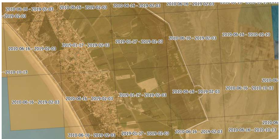
Figure 3.3 : Dates des levés utilisés par dalles pour produit RGE ALTI® V2-0 sur le secteur Nord de Barbâtre (IGN).
