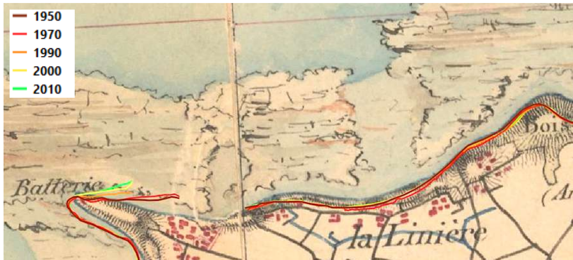
Figure 6.52 : Comparaison de la carte de l'état-major et des traits de côte de 1950 à 2010 au droit du port de l'Herbaudière et de la plage de la Linière.
