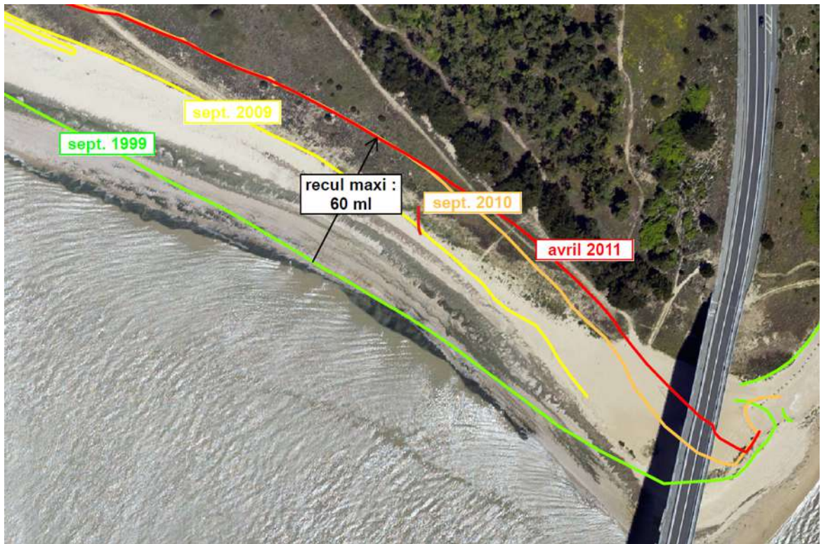
Figure 6.120 : Evolutions du trait de côte de septembre 1999 à avril 2011 au droit de la pointe de la Fosse (CCIN).
