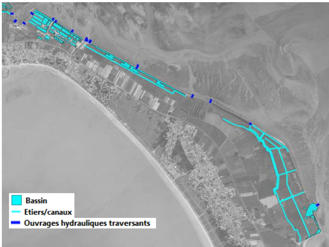
Figure 9.1 : Ensemble du réseau hydrographique de l'île de Noirmoutier avec localisation des ouvrages traversants.
