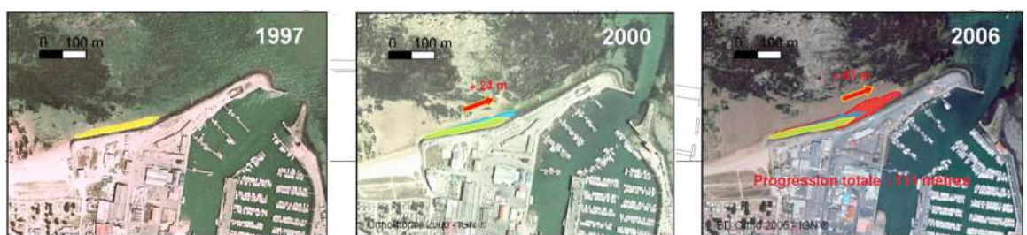
Figure 6.51 : Progression de la flèche sableuse au droit de la digue Ouest du port de l'Herbaudière entre 1997 et 2006 (CCIN).
