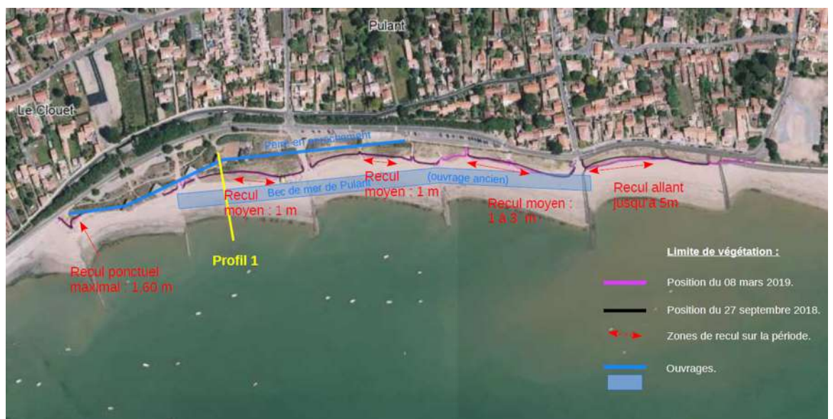
Figure 6.107 : Suivi du trait de côte dans le fond de l'anse de la Guérinière : état du 8 mars 2019 (OR2C).
