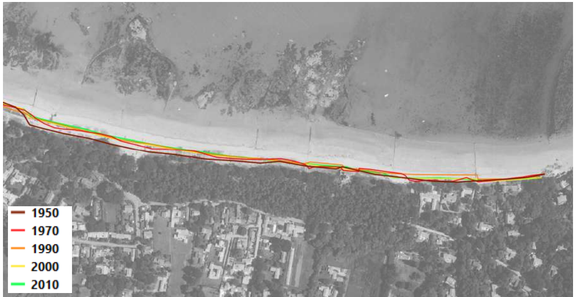
Figure 6.66 : Traits de côte de 1950 à 2010 superposés à la photographie aérienne de mai 2022 au droit du perré de la Clère (ouvrages de protection non représentés).
