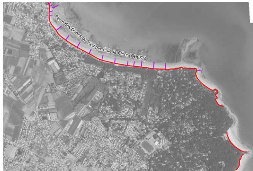
Figure 6.62 : Ouvrages de protection au droit de l'anse de la Clère et des pointes NE de l'île.
