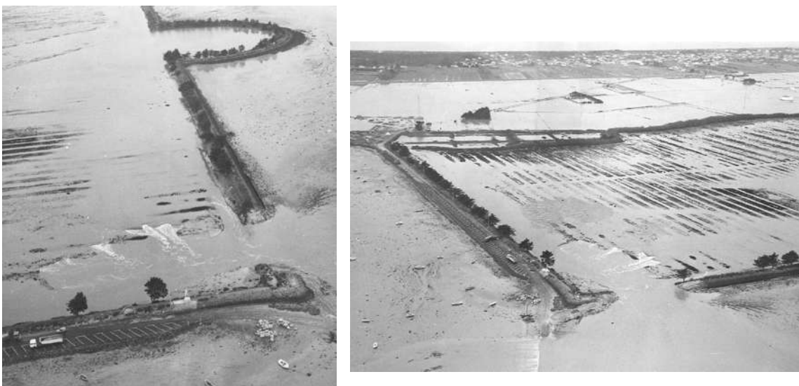
Figure 10.14 : Photographies de la brèche dans la digue du polder de Sébastopol et de l'inondation en arrière fin 1978/début 1979.
