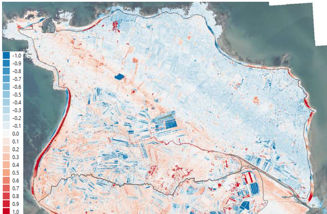
Figure 6.23 : Différences altimétriques entre le levé LiDAR PCRS (2022) et celui du Litto3D (2010).
