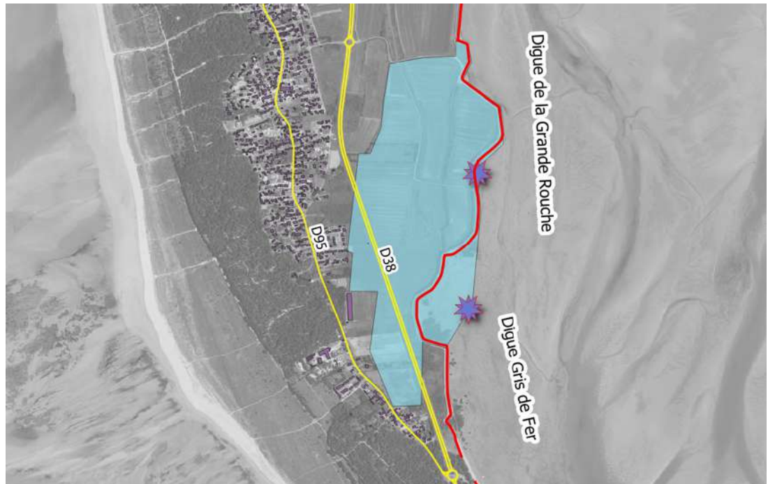
Figure 10.6 : Positionnement des brèches et emprise de la submersion de mars 1937 proposés au droit de Barbâtre : sur le fond de la carte de l'IGN de 1950, en haut, et sur la photoaérienne de 2022 avec bâti actuel, en bas.
