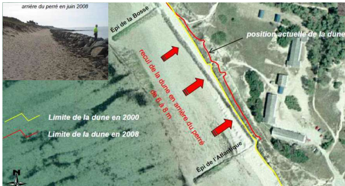
Figure 6.91 : Suivi du trait de côte dans le secteur de la Bosse entre 2000 et 2008 (CCIN).
