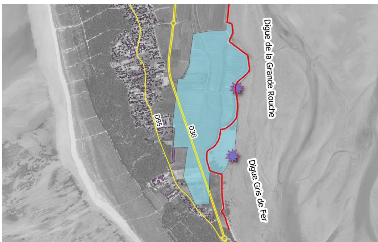
Figure 17 : Positionnement des brèches (étoiles violettes) et emprise de la submersion de mars 1937 au niveau de Barbâtre (zones submergées représentées en bleu)
