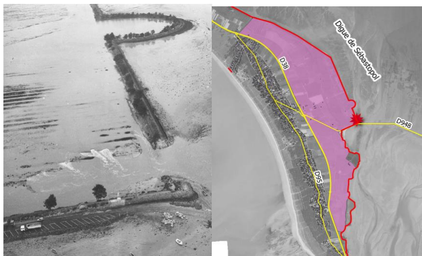
Figure 18 : Positionnement des brèches et emprise de la submersion au niveau de la façade Est de Barbâtre
